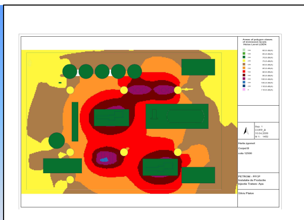
Fig. 4.9. Harta de zgomot PFCP-Corp C1: Injecție și tratare apă, Cota 12500
